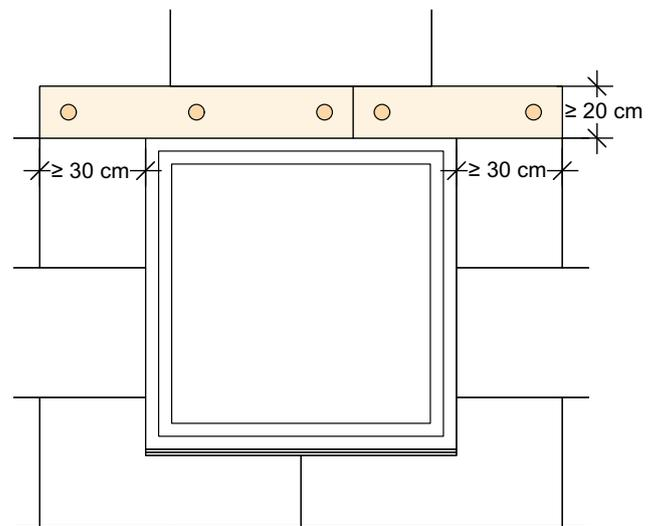
Beispiel für die Ausführung und Anordnung des Brandschutzriegels bei der Verwendung des Plattenformats 1200 mm x 200 mm
