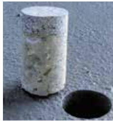
Creteo®Phalt su supporto conglomerato con legante idraulico
