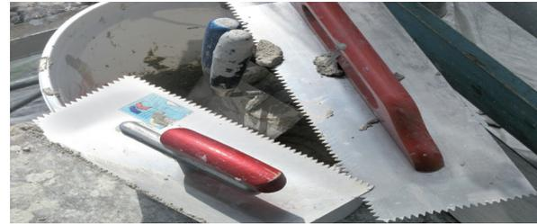
...pettinare leggermente l'intonaco di finitura minerale ancora fresco, per eliminare le ultime bolle d'aria. Lasciare indurire la struttura della superficie.
