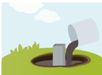
**2** Versare il materiale a secco con spessore massimo di 20 cm per strato
