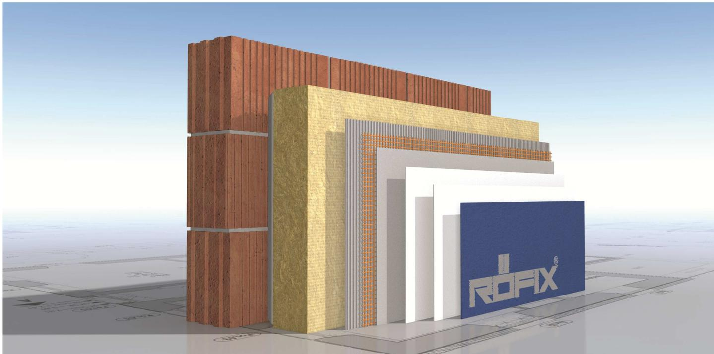
Sistema d'isolamento termico a cappotto con pannelli in plana di roccia, omologato secondo ETAG 004. Il sistema di isolamento termico **RÖFIX SycoTec** consente di realizzare facciate isolate con colori intensi, ed elevata resistenza agli urti ed elevata protezione contro alghe e muffe. Reazione al fuoco Euroclasse A2-s1-d0.
