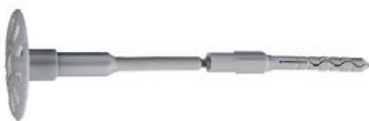
Schraubdübel mit langem Spreizbereich. Universell einsetzbar im Neu- und Altbau, geeignet insbesondere für unverputzte und verputzte Beton-, Vollstein- und Ziegeluntergründe sowie Porenbeton. Type: ISOFUX. Nutzungskategorie: A/B/C/E. Verankerungstiefe: 25 mm bzw. 50 mm (Porenbeton). Altputzdicke 5–15 mm.
