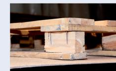
Sichtbare Befestigungselemente z.B. Nägel
