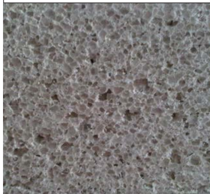
Querschnitt des ausgehärteten Hochleistungsdämmputzes
