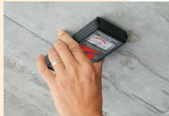
Avant l'application du pont d'adhérence, la teneur en humidité autorisée d'un support en béton est de max. 3 % de la masse.
